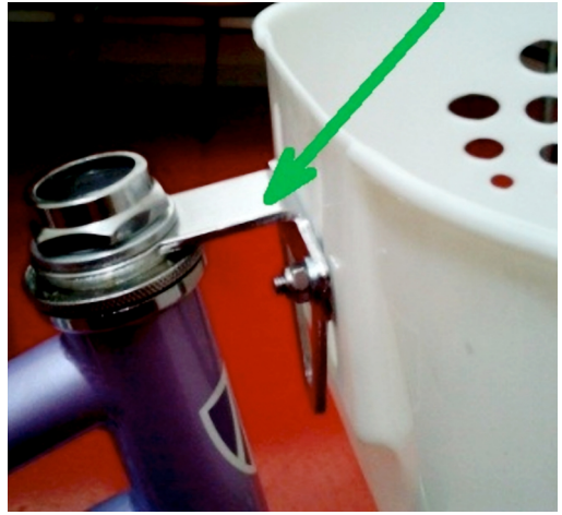
Primjer: Oštri rubovi nosača košarice
