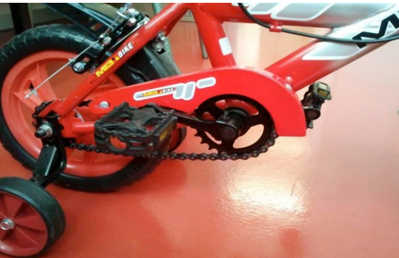
Primjer: Opasnog bicikla bez adekvatne zaštite lanca
