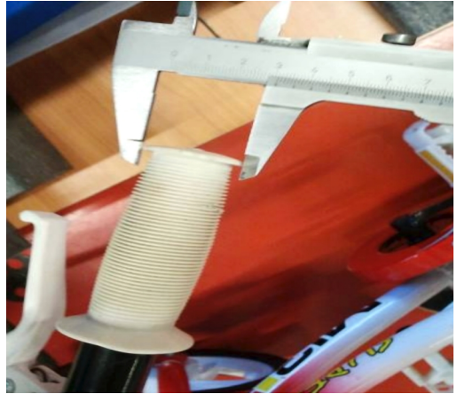
Primjer: Ručka upravljača neodgovarajućih dimenzija
